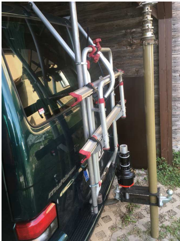
Obr. 3 a 4 – ukázka fixace stožáru před zvedáním a následné zvednutí a upnutí do rotátoru na připravený trn s fixací
