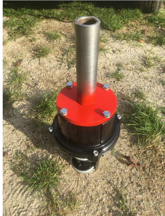
Obr. 1 a 2 – ukázka malého rotátoru G450 a provedení montážní desky s trnem.
