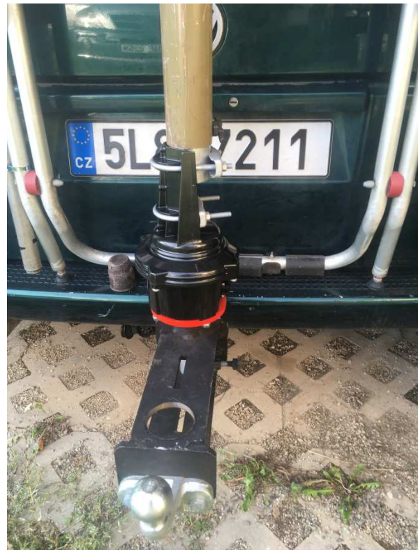
Obr. 3 a 4 – ukázka fixace stožáru před zvedáním a následné zvednutí a upnutí do rotátoru na připravený trn s fixací
