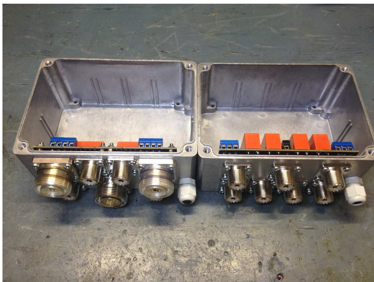
Obr. 10 Finální provedení anténního přepínače
