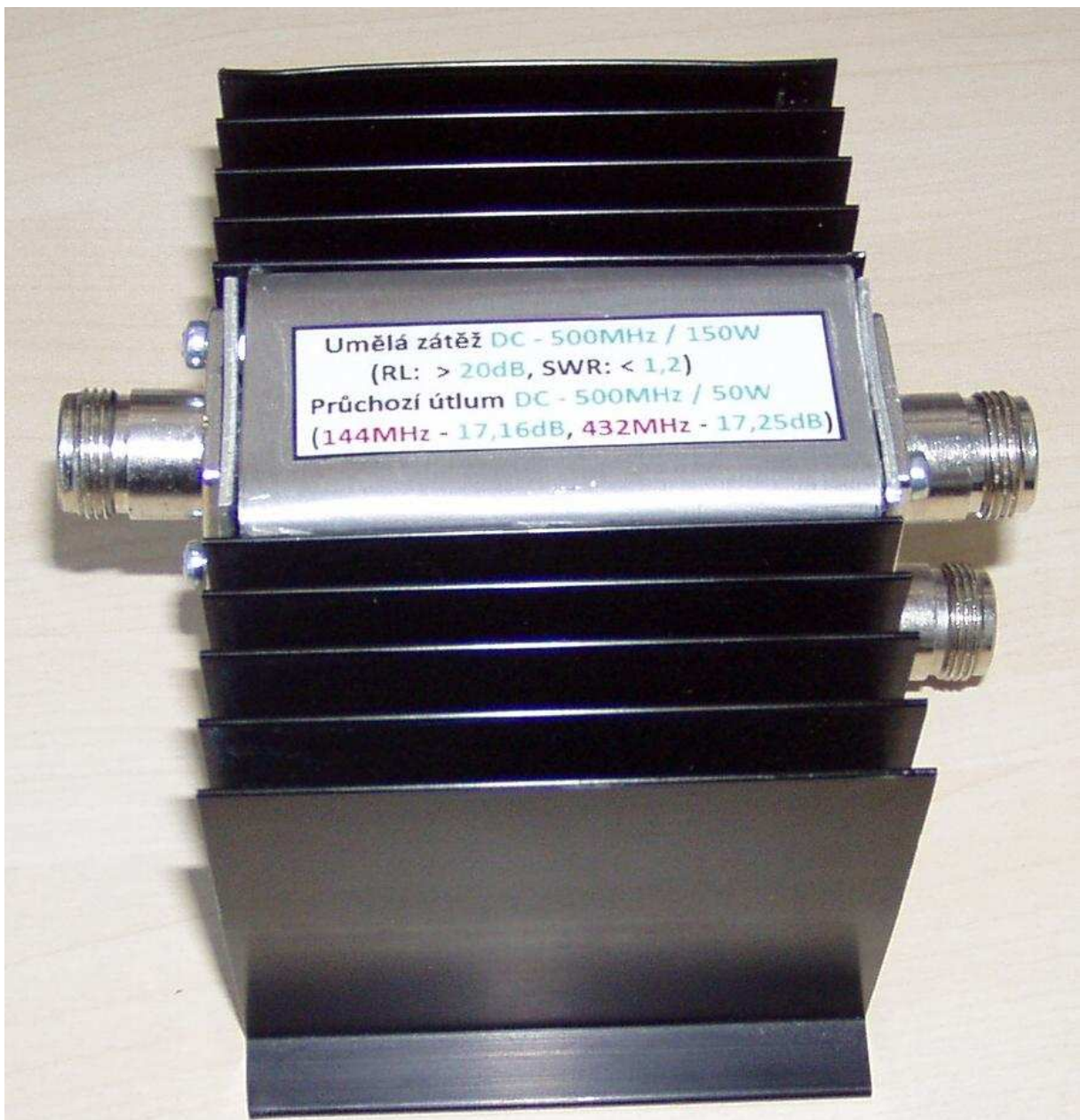
Obr.1 Hotová zátěž a průchozí útlum za pár korun.
