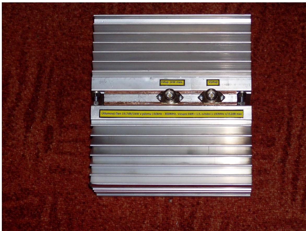
Finální provedení průchozího útlumu 20dB/1kW
