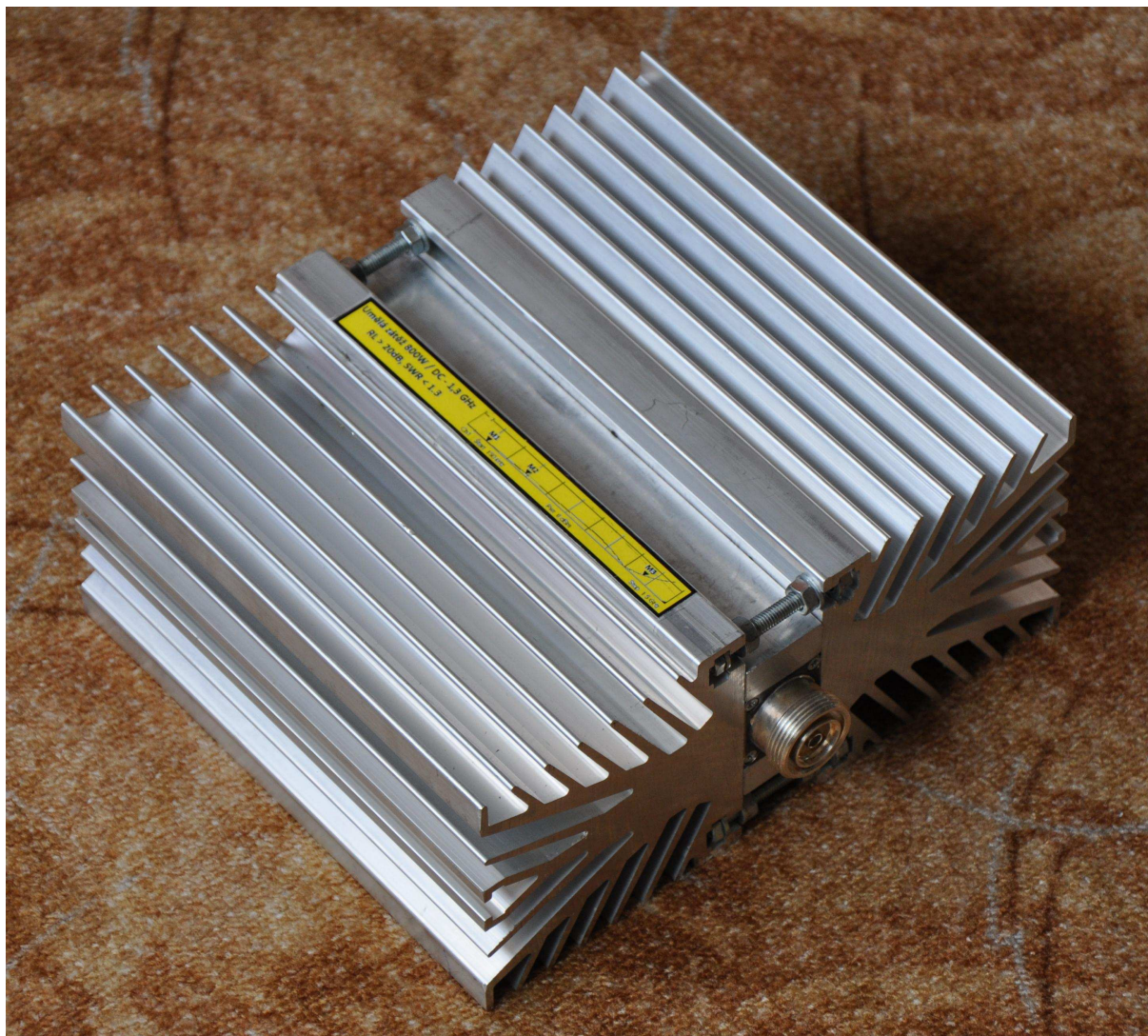
Obr.5 Finální mechanické provedení umělé zátěže 800 W do 1.296 GHz.
