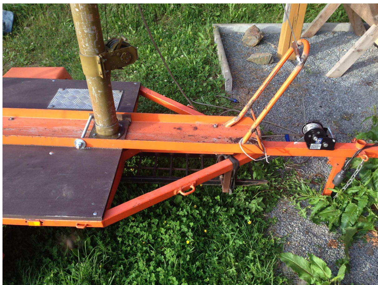
Obr.2 Spodní kloub a připojení navijáku přes pomocnou kladku.
