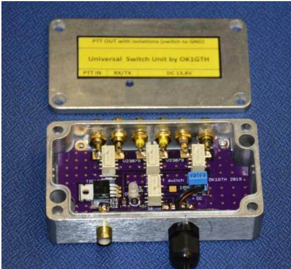
Obr. 4 Vnitřní uspořádání spínací jednotky
