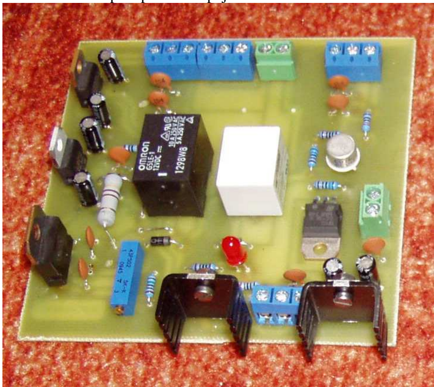
Obr.4 Hotová osazená deska plošného spoje triode board.
