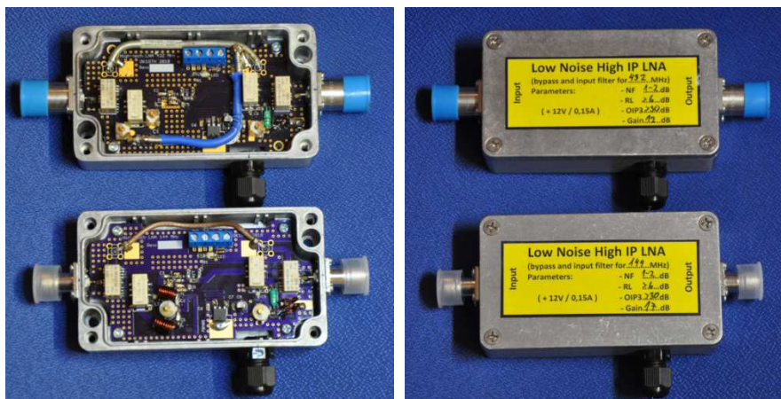
Finální provedení LNA s SPF5043Z
