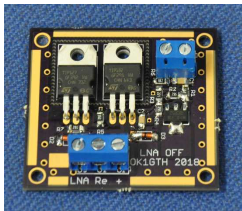
Osazovací plán a provedení jednoduchého přepínacího obvodu pro LNA
