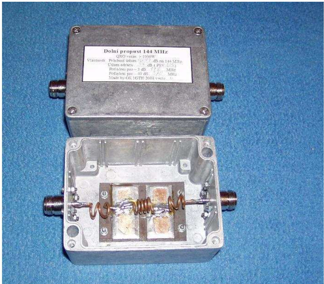
Obr.5 Hotový a naladěný filtr na 144 MHz.
