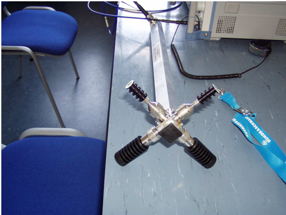
Obr.7 Detail použitých umělých zátěží.
