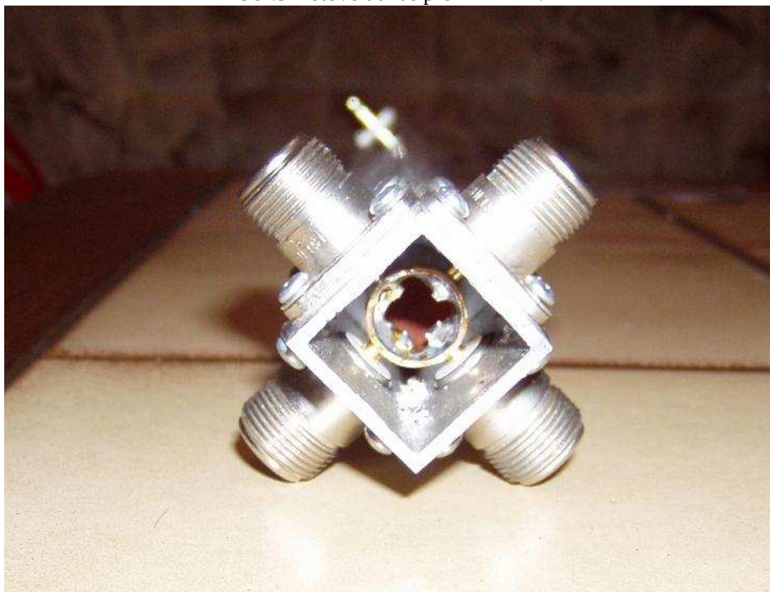
Obr.4 Detail provedení děliče.
