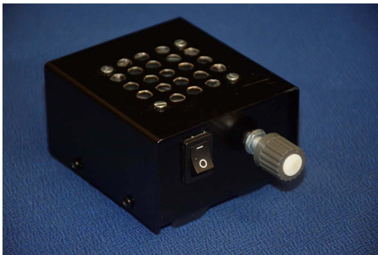
Obr. 7 Finální provedení CW generátoru v krabičce
