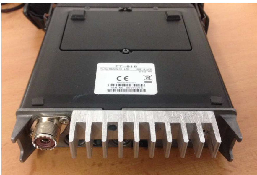
Zadní panel s namontovaným chladičem
