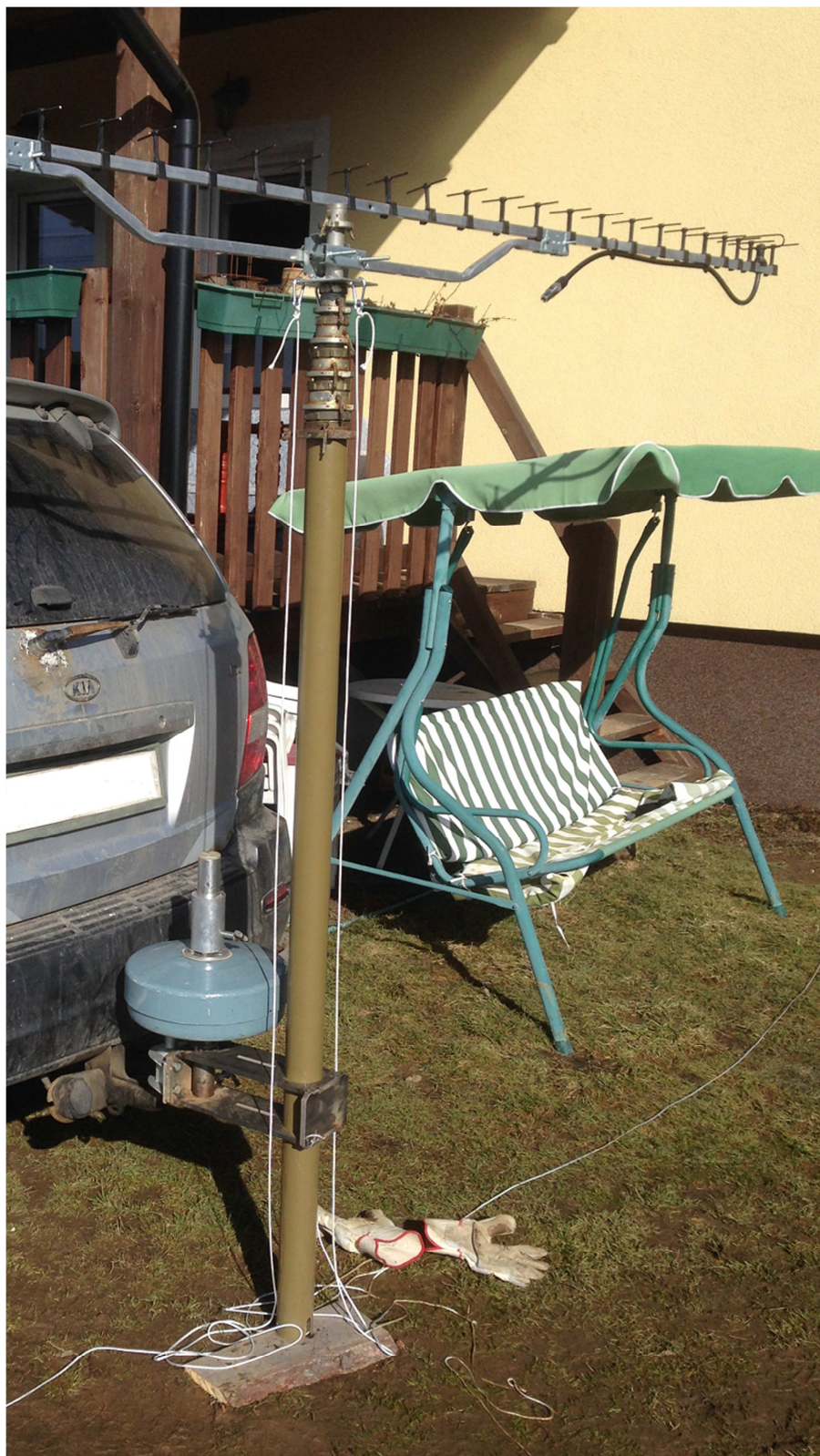
Obr. 10 Stožár v konzoli před nasunutím na rotátor
