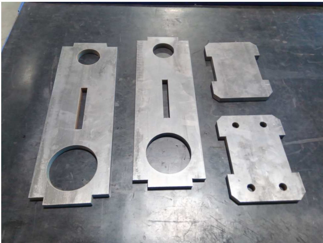
Obr. 6 Polotovary po vyřezání CNC vodním paprskem
