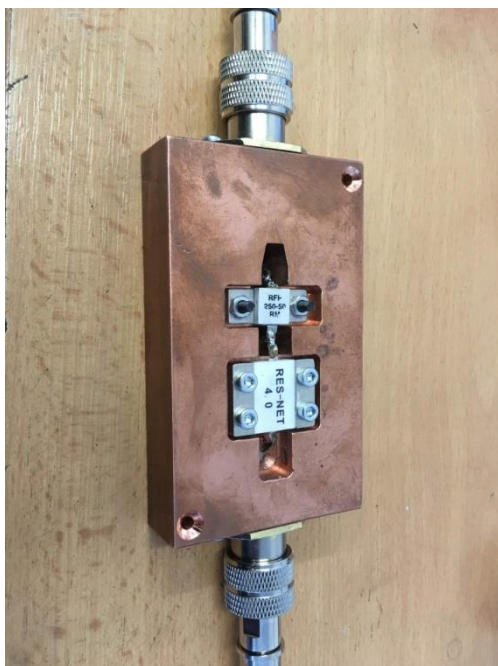
Obr. 8 První dva prototypy, kde se nepodařilo dosáhnout vyšší šířky pásma, než 200 MHz
