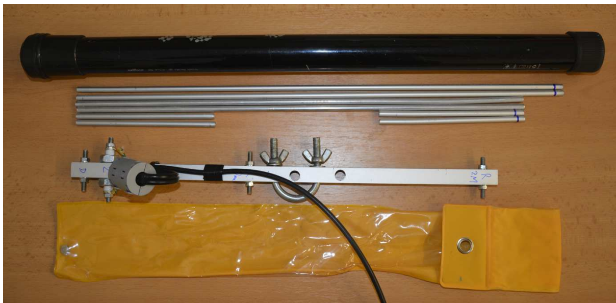
Obr. 10 Finální provedení složené antény včetně skládacího laminátového stožáru 5 m
