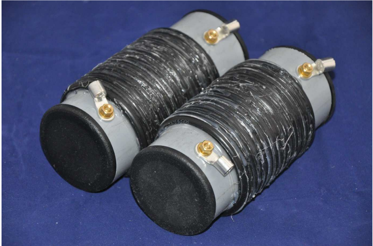
Obr. 6 Jedno z možných řešení provedení koaxiálního trapu
